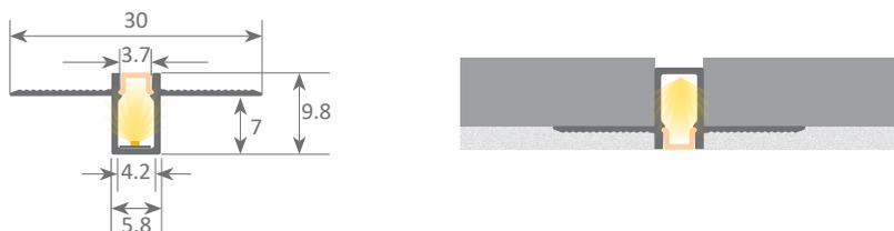
Led profile de aluminio + difusor para aplicaciones de techo que permite quedar enrasado con las placas de yeso convencionales. Su línea de luz con solo 3.7mm ofrece una iluminación muy fina y elegante.
