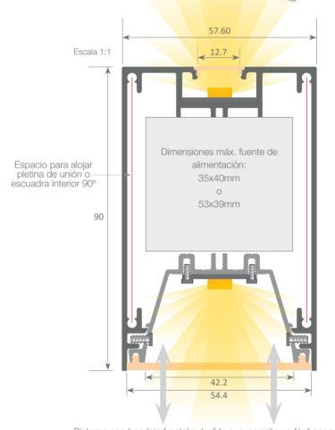
Sistema con bandeja frontal extraíble que permite un fácil acceso a la tira de led y fuente de alimentación, permitiendo así un mantenimiento muy rápido y sencillo de la instalación eléctrica.
