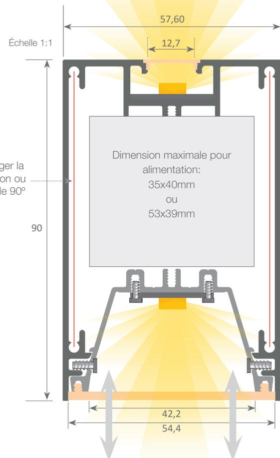
Système avec plateau frontal amovible qui permet un accès facile à la bande led et à l'alimentation, permettant ainsi une maintenance très rapide et facile de l'installation électrique.
