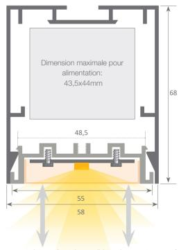
Système avec plateau frontal amovible qui permet un accès facile à la bande led et à l'alimentation, permettant ainsi une maintenance très rapide et facile de l'installation électrique.
