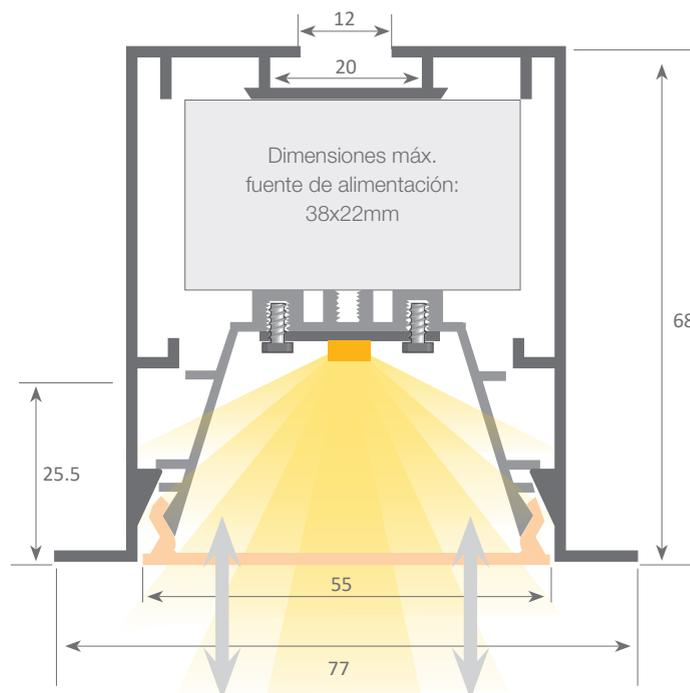
Sistema con bandeja frontal extraíble que permite un fácil acceso a la tira de led y fuente de alimentación, permitiendo así un mantenimiento muy rápido y sencillo de la instalación eléctrica.
