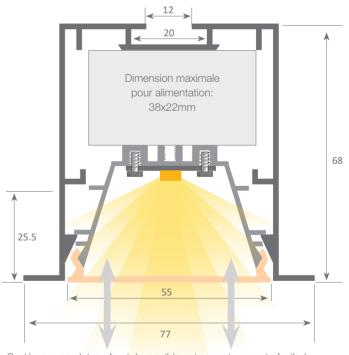
Système avec plateau frontal amovible qui permet un accès facile à la bande led et à l'alimentation, permettant ainsi une maintenance très rapide et facile de l'installation électrique.
