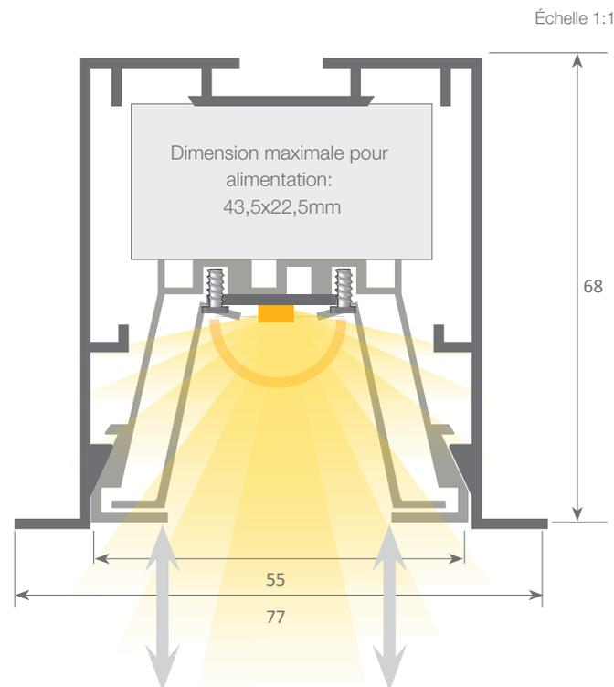
Système avec plateau frontal amovible qui permet un accès facile à la bande led et à l'alimentation, permettant ainsi une maintenance très rapide et facile de l'installation électrique.
