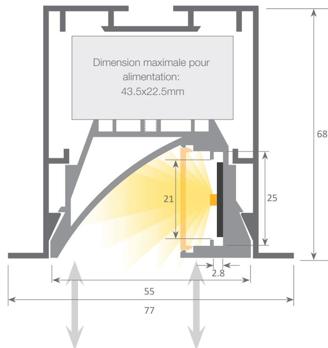
Système avec plateau frontal amovible qui permet un accès facile à la bande led et à l'alimentation, permettant ainsi une maintenance très rapide et facile de l'installation électrique.
