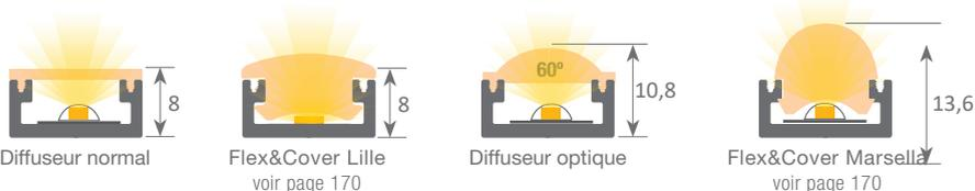
En appliquant le diffuseur de lentille sur le profil Milano avec la bande LED flexible, nous obtenons un faisceau lumineux de 60 °.
