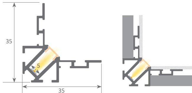
Profil architectural en aluminium + diffuseur d'angle intérieur. Il se conclut à l'aide d'une couche de plâtre en le laissant complètement intégré au mur.
