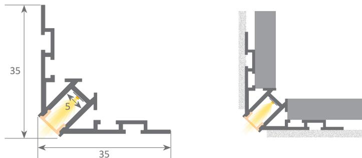
Profil architectural en aluminium + diffuseur d'angle intérieur. Il se conclut à l'aide d'une couche de plâtre en le laissant complètement intégré au mur.
