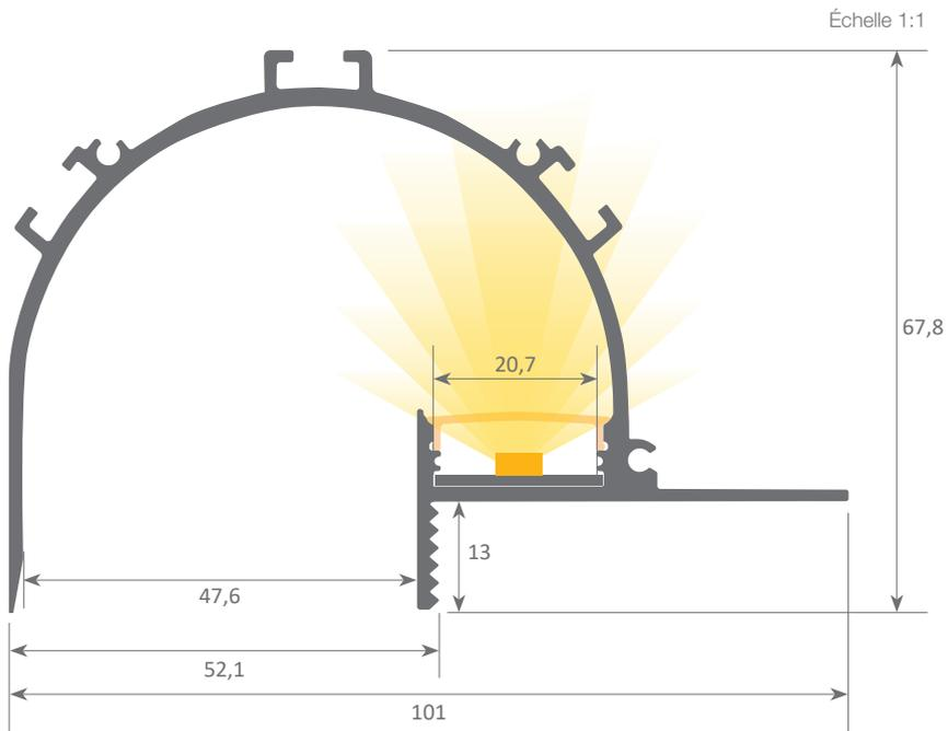
Profil en aluminium + diffuseur conçu pour offrir un éclairage périmétral au plafond, avec une lumière diffuse et d'ambiance. Il se conclut à l'aide d'une couche de plâtre qui le laisse complètement intégré au mur.
