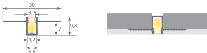
Profil en aluminium + diffusant pour application au plafond qui permet d'être ajusté avec les plaques de plâtre conventionnelles. La ligne de lumière, de seulement 3,7mm de large, offre un éclairage fin et élégant.
