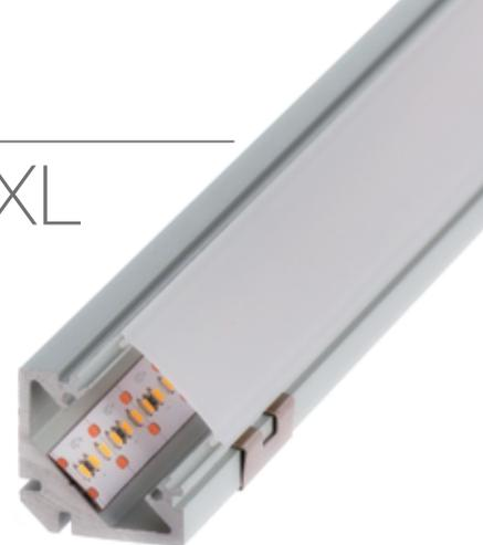
led profile serie PROFESIONAL angular, fabricado en aluminio de alta pureza, anodizado en plata, negro y lacado en blanco. Ideal para aplicaciones de superficie en paredes, muebles, estanterías y similares donde precisemos un perfil con un ancho superior al estándar permitiendo así el uso de tiras led más anchas, con una mayor disipación térmica y un ancho mayor en proyección de luz.
