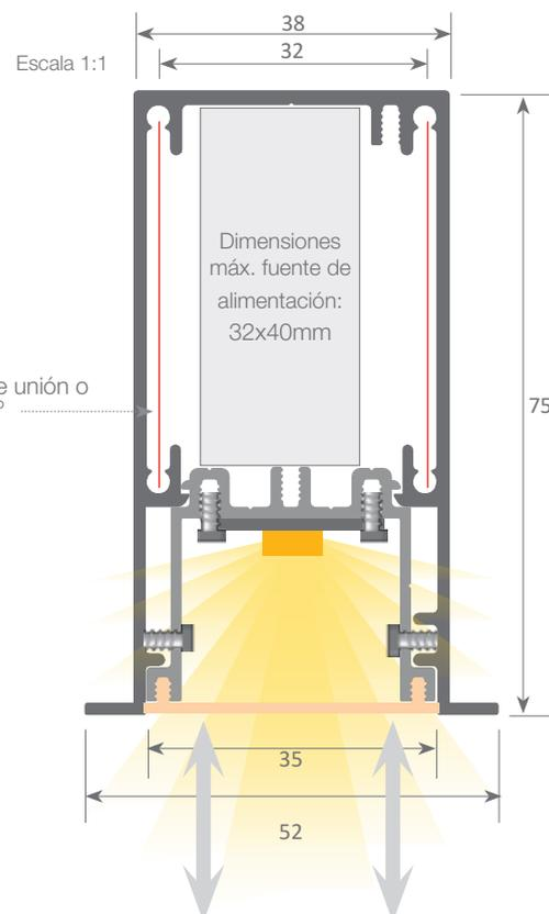
Sistema con bandeja frontal extraíble que permite un fácil acceso a la tira de led y fuente de alimentación, permitiendo así un mantenimiento muy rápido y sencillo de la instalación eléctrica.
