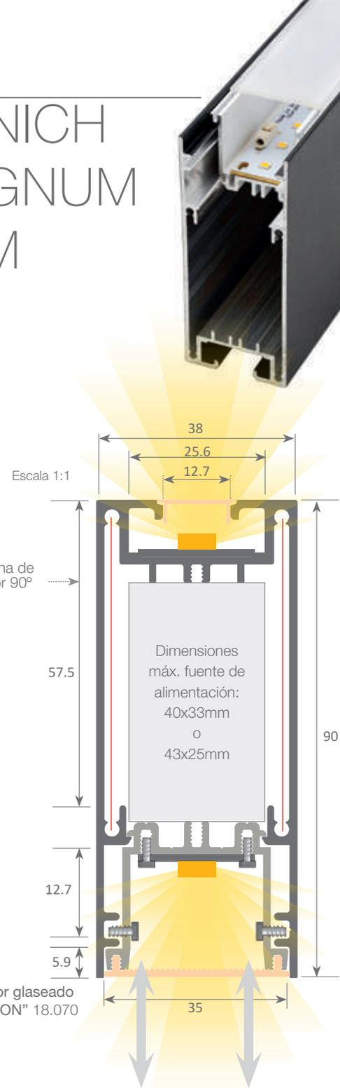
Sistema con bandeja frontal extraíble que permite un fácil acceso a la tira de led y fuente de alimentación, permitiendo así un mantenimiento muy rápido y sencillo de la instalación eléctrica.
