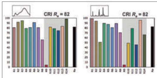
El CRI con sus quince valores (colores) no es lo suficientemente completo como para realizar una prueba de calidad óptima. Esto es debido a que al solo tener en cuenta 15 valores podemos falsear un supuesto. El CRI no puede impedir que uno diseñe una fuente de luz, con el propósito específico de tener una buena puntuación en esos quince colores mientras que tiene un espectro de color pobre en general (ver foto donde 2 valores con CRI idéntico ofrecen un espectro lumínico muy diferente).
