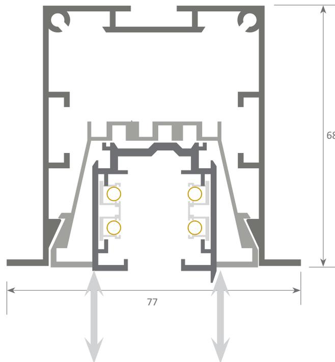
Sistema con bandeja frontal extraíble que permite un fácil acceso a la tira de led y fuente de alimentación, permitiendo así un mantenimiento muy rápido y sencillo de la instalación eléctrica.
