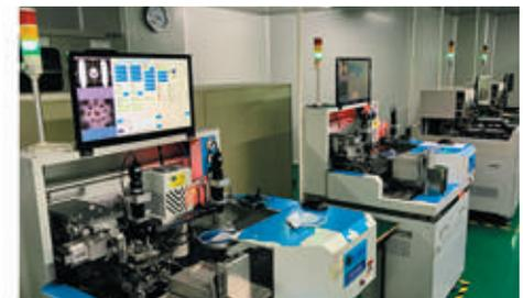
Las máquinas utilizadas tienen uno o dos cabezales, que toman las virutas de la placa base y luego las pegan sobre la matriz con un pegamento especial.
