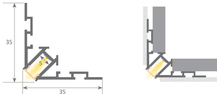
Led profile de aluminio + difusor arquitectónico esquinero exterior para integrar en pared. Se remata mediante una capa de yeso quedando completamente integrado en la pared.
