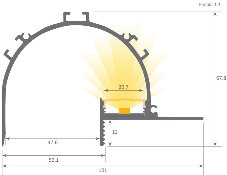
Led profile de aluminio + difusor destinado a ofrecer una iluminación perimetral de techo en estancias mediante una luz difuminada y ambiental. Se remata mediante una capa de yeso quedando completamente integrado en la pared.
