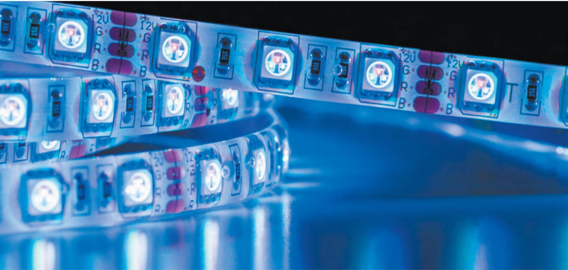
Tiras flexibles RGB (3 chips en el mismo diodo). Se puede controlar el color por medio de un controlador o secuenciador. Todos los leds en la tira flexible RGB muestran el mismo color al mismo tiempo.
