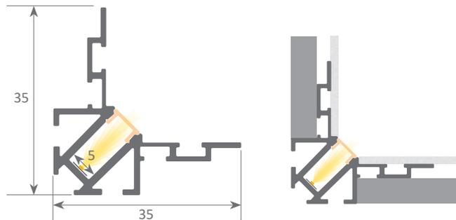
Led profile de aluminio + difusor arquitectónico esquinero interior para integrar en pared. Se remata mediante una capa de yeso quedando completamente integrado en la pared.
