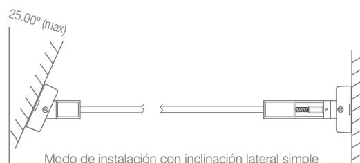
Modo de instalación con inclinación lateral simple
