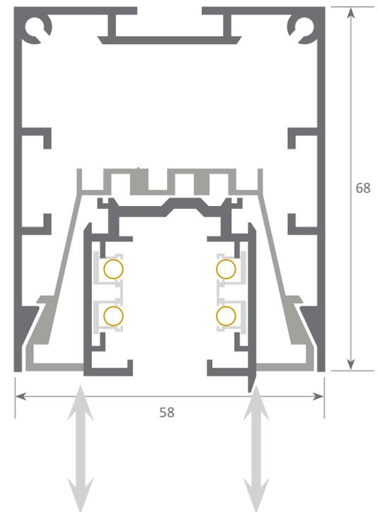
Sistema con bandeja frontal extraíble que permite un fácil acceso a la tira de led y fuente de alimentación, permitiendo así un mantenimiento muy rápido y sencillo de la instalación eléctrica.
