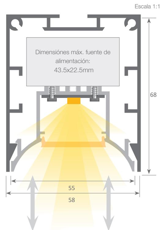
Sistema con bandeja frontal extraíble que permite un fácil acceso a la tira de led y fuente de alimentación, permitiendo así un mantenimiento muy rápido y sencillo de la instalación eléctrica..
