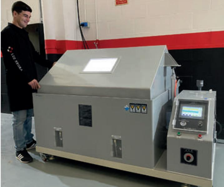
En esta máquina se realizan las pruebas de control de calidad más agresivas exponiendo productos y luminarias no solo a una vaporización de agua constante, sino también a un alto grado de salinidad para comprobar de qué forma afecta la corrosión a los productos testeados.
