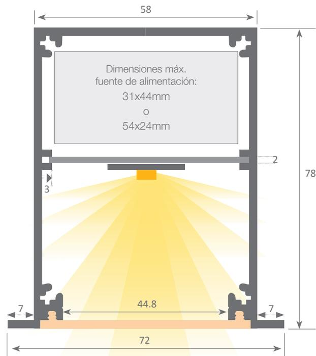
Normativas extrusión: ISO 9001:2008 - ISO 14001 / Tolerancias según norma: UNE-EN 755-9 / UNE-EN 12020-2
