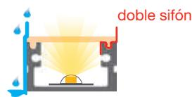
El doble sifón evita que se filtre humedad o agua en el interior.
