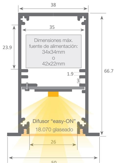
Normativas extrusión: ISO 9001:2008 - ISO 14001 / Tolerancias según norma: UNE-EN 755-9 / UNE-EN 12020-2
