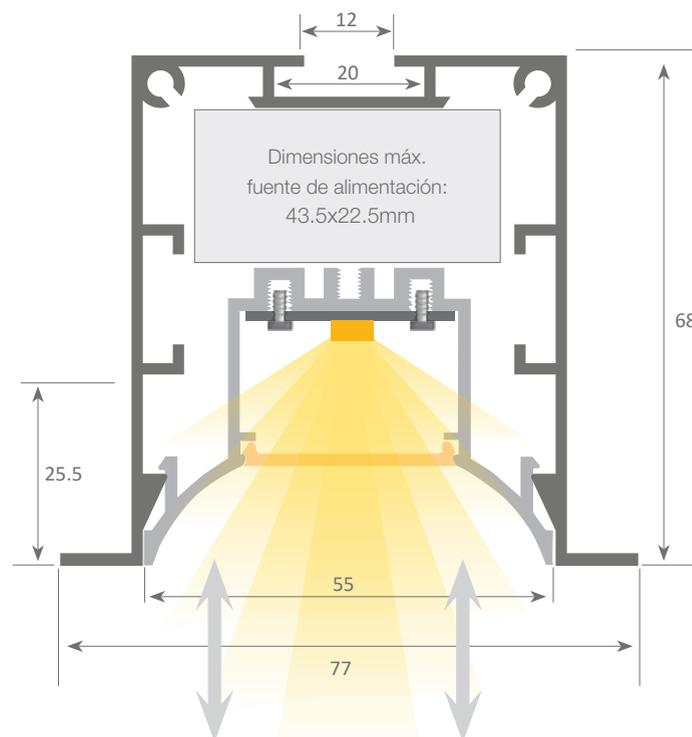
Sistema con bandeja frontal extraíble que permite un fácil acceso a la tira de led y fuente de alimentación, permitiendo así un mantenimiento muy rápido y sencillo de la instalación eléctrica.
