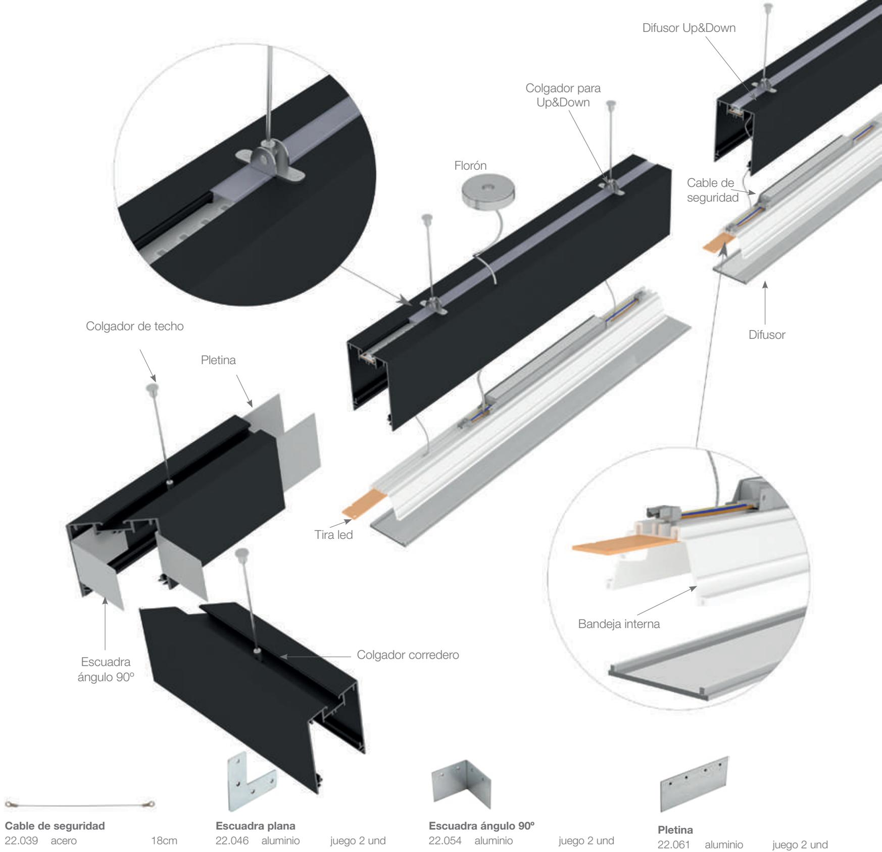
led profile serie PROFESIONAL colgante/superficie fabricado en aluminio de alta pureza, anodizado en plata, lacado en blanco y negro texturado. Ideal para aplicar en techos colgantes o de superficie. En paredes como aplique permite iluminación Up&Down, pero solo con el perfil anodizado en plata.. Permite alojar los drivers en su interior.
