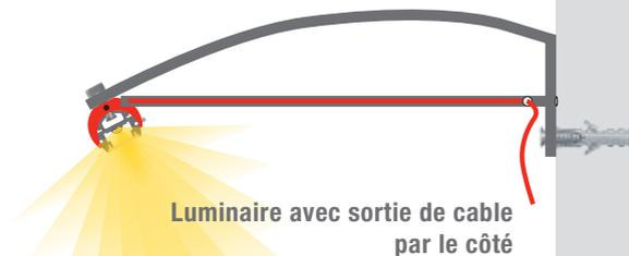
Luminaire avec sortie de câble
