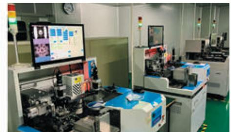
Les machines utilisées ont une ou deux têtes, qui prennent les chips de la plaque de base pour ensuite les coller sur la matrice avec une colle spéciale.
