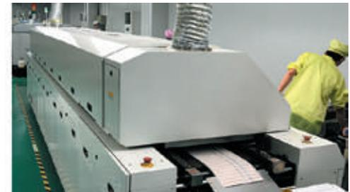
Four de séchage fixant les soudures
