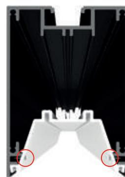
Vis de passage de platine au profil
