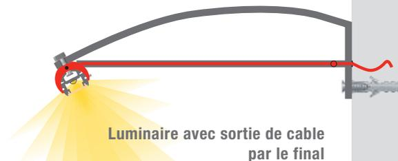
Luminaire avec sortie de câble
