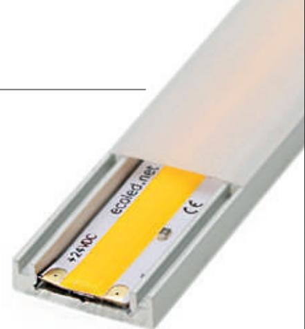
led profile de surface série PROFESSIONNELLE de seulement 4,05mm de profondeur, fabriqué en aluminium de haute pureté et disponible en deux couleurs différentes (le profil peut être également fourni en aluminium brut, sans laquage).
