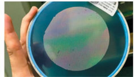
Plaque de base avec plus de 15.000 chips (diodes)
