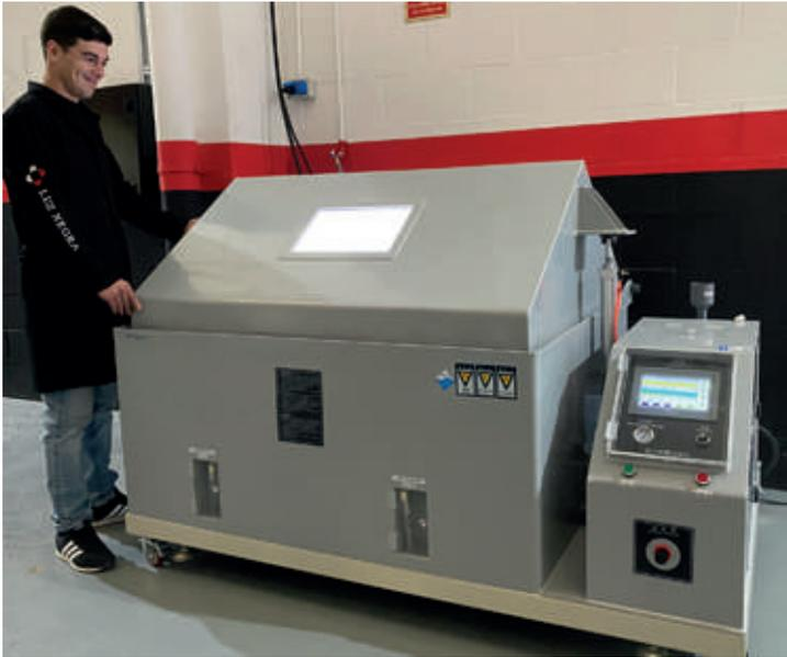
Dans cette machine sont réalisés les tests de contrôle qualité plus agressifs exposant des produits et des luminaires non seulement à une vaporisation d'eau constante, mais également à un haut taux de salaison pour contrôler de quelle manière la corrosion affecte les produits testés.
