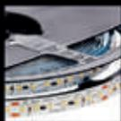
**RUBAN LED:** Ghost Profile est extrudé à froid en y incorporant à l'intérieur la bande de led. Il compte 140 leds/m SMD2835 (14W/m) avec 1.500 Lm/m, offrant quasiment 110 Lumens par W de consommation.
