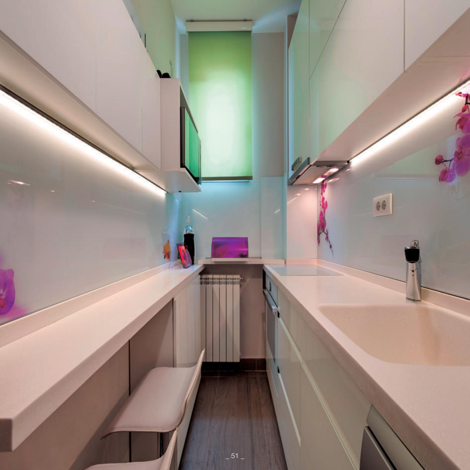
led profile serie PROFESIONAL de superficie, fabricado en aluminio de alta pureza, anodizado en plata, negro y lacado en blanco. Ideal para aplicaciones de superficie en paredes, muebles, estanterías y similares donde precisemos un perfil con un ancho superior al estándar permitiendo así el uso de tiras led más anchas, con una mayor disipación térmica y un ancho mayor en proyección de luz.
