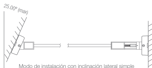
Modo de instalación con inclinación lateral simple
