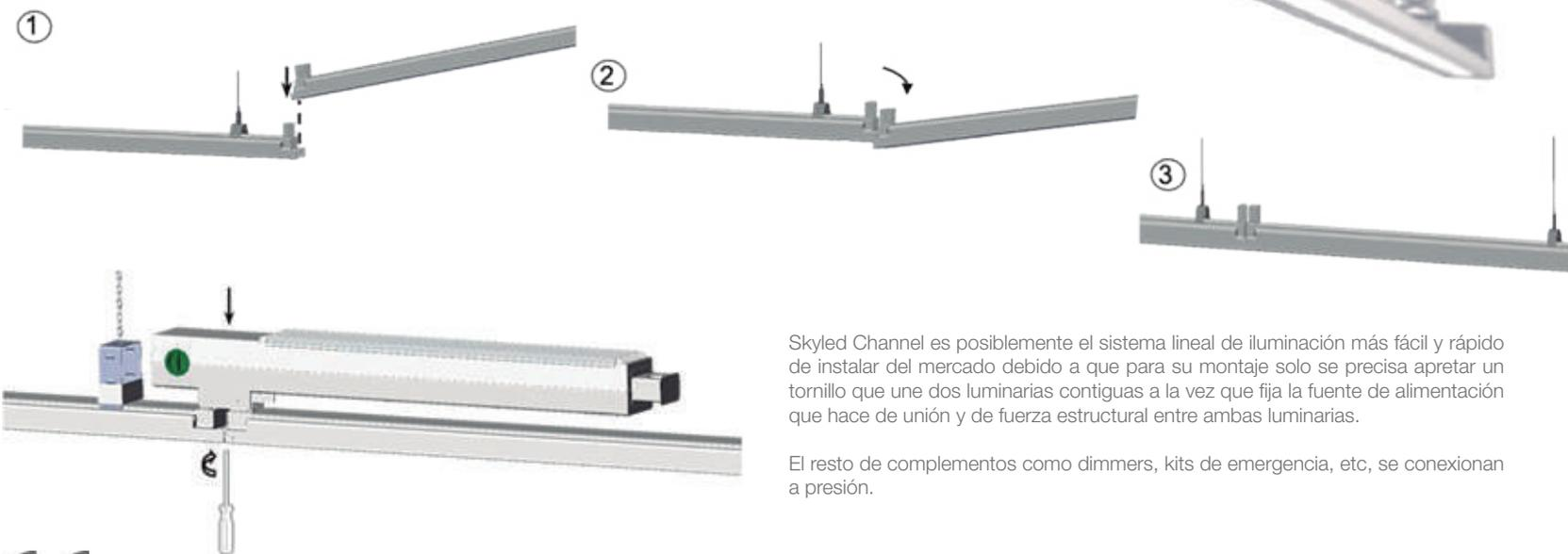
Skyled Channel es posiblemente el sistema lineal de iluminación más fácil y rápido de instalar del mercado debido a que para su montaje solo se precisa apretar un tornillo que une dos luminarias contiguas a la vez que fija la fuente de alimentación que hace de unión y de fuerza estructural entre ambas luminarias.
