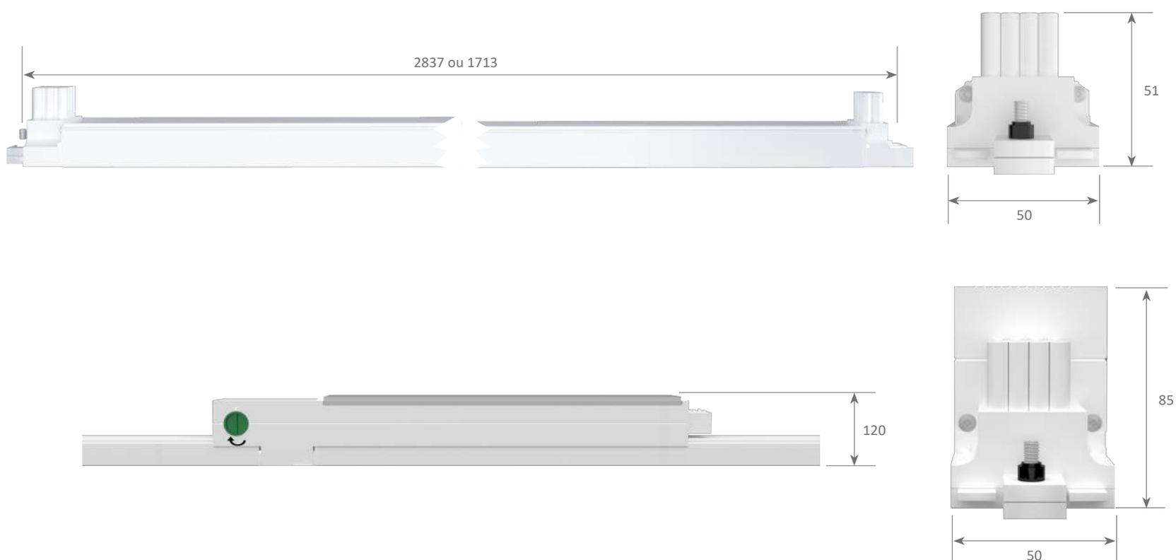
Les luminaires sont disponibles en 2 longueurs : 2837mm et 1713mm et sont servis laqués en blanc ou noir. Ils possèdent à l'intérieur la canalisation de 8 câbles, 3 phases (système triphasé) + neutre + terre + urgence + 2 câbles pour le système DALI.
