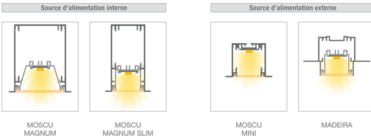
Ampérage : 700mA – bande rigide de 20mm de largeur – Les Lumens reflétés correspondent à la bande rigide de 4000°K (165 Lm/W).
