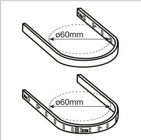
4. Le diamètre de cintrage des bandes flexibles ne doit pas être supérieur à 60mm.
