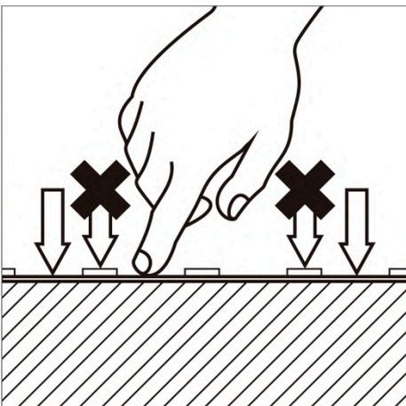
7. Lors de l'application de la bande, appuyez entre les led et non pas sur la surface de la led.
