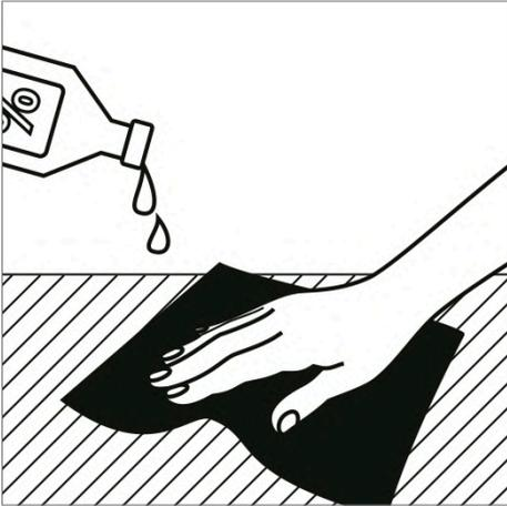
1. Nettoyer la surface d'installation de la saleté et de la graisse.
