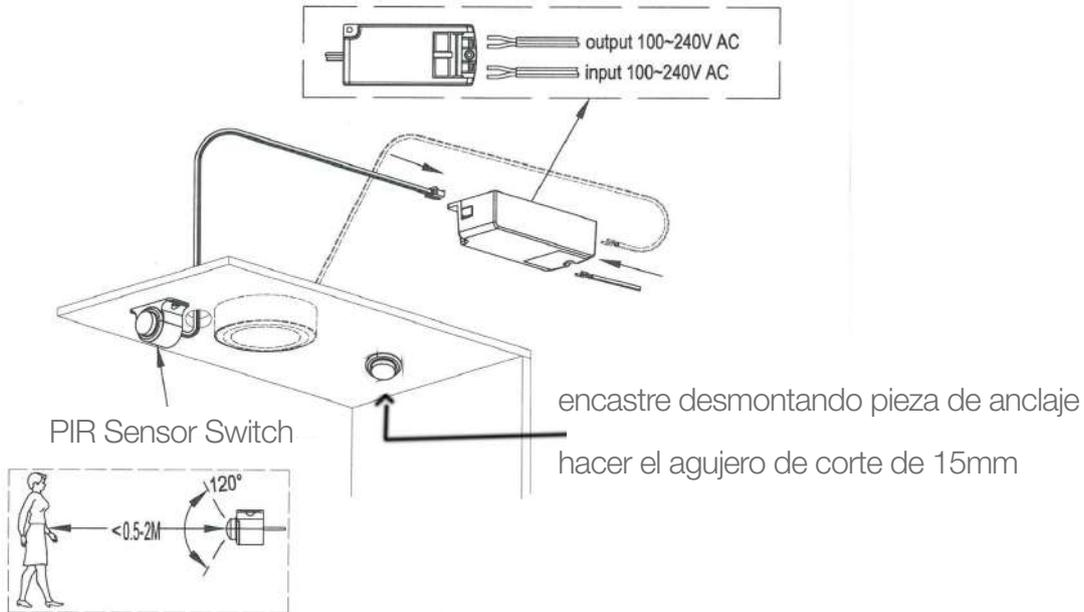
Esquema de conexión:
