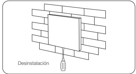
4. Inserte el destornillador en la bayoneta del panel, haga palanca para desmontarlo.
