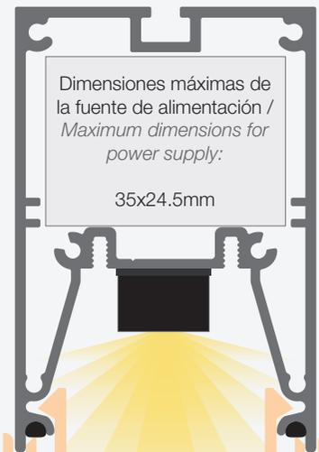
Dimensiones máximas de la fuente de alimentación / Maximum dimensions for power supply:
