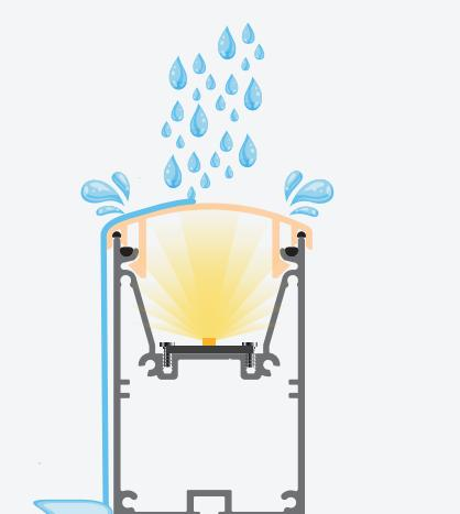
Perfiles de aluminio IP65 con nuestro sistema patentado "easy-ON" para la fabricación de luminarias colgantes, de superficie y de encastre. Sistema de bandeja extraíble frontal con triple sistema de seguridad (consultar modelos). / Aluminium profiles with our patented "easy-ON" system, offering an IP65 rating and designed for hanging, recessing and surface applications. Front removable tray with triple safety system (consult models).
