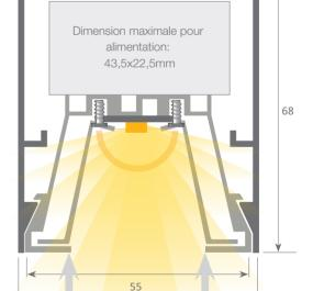
Système avec plateau frontal amovible qui permet un accès facile à la bande led et à l'alimentation, permettant ainsi une maintenance très rapide et facile de l'installation électrique.
