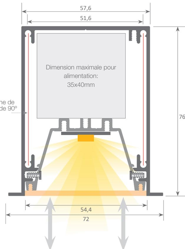
Système avec plateau frontal amovible qui permet un accès facile à la bande led et à l'alimentation, permettant ainsi une maintenance très rapide et facile de l'installation électrique.
