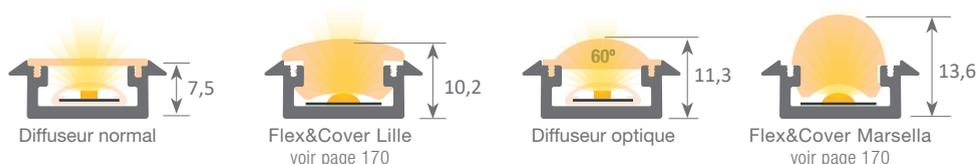
En appliquant le diffusant lentille sur le profil Frankfurt, avec la bande flexible de led nous obtenons un halo de lumière de 60°.
