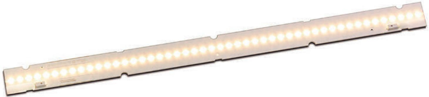
En comparación con las tiras flexibles que normalmente funcionan a 12V o 24V en tensión continua, las tiras rígidas funcionan en intensidad constante. La mayoría de las tiras rígidas de este catálogo pueden funcionar a 350-500 o 700 mA (miliamperios).
