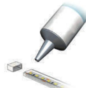
7. Fixer le silicone au bout de la bande et l'embout final.
