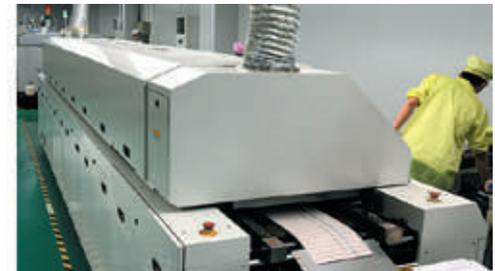
Four de séchage fixant les soudures
