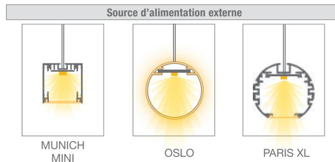
Ampérage : 700mA – bande rigide de 20mm de largeur – Les Lumens reflétés correspondent à la bande rigide de 4000°K (165 Lm/W).
