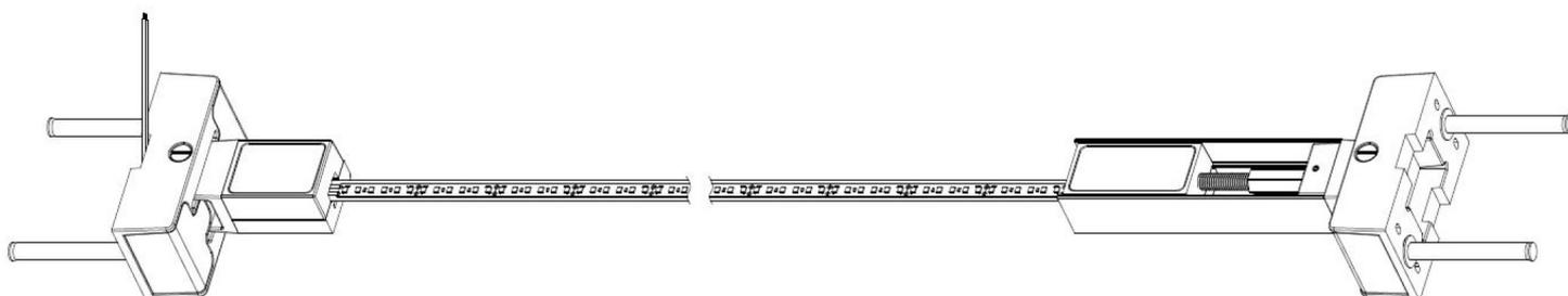
Soft Line est un nouveau concept de luminaire linéaire pour l'éclairage indirect des murs et des plafonds. Il se compose de deux supports qui sont fixés aux murs, plafonds ou planchers, tous deux reliés par une fine platine en acier où nous fixerons la bande led que nous souhaitons utiliser. La bande d'acier mesure 30 mètres, pouvant la couper pour ajuster la taille de notre luminaire.
