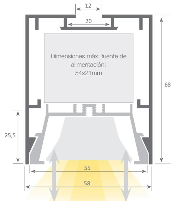
Sistema con bandeja frontal extraíble que permite un fácil acceso a la tira de led y fuente de alimentación, permitiendo así un mantenimiento muy rápido y sencillo de la instalación eléctrica.
