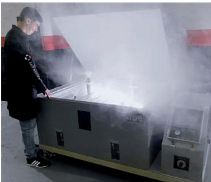
Cámara de niebla salina que nos permiten medir el nivel de estanqueidad y de salinidad que soportan los productos utilizados en los rótulos.
