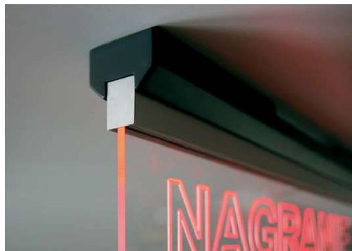
Rótulos de luz filtrante compuestos por un perfil de aluminio (modelo Hannover o Ginebra) anodizado en plata que incorpora en su interior una tira de ecoled Cies. El led ilumina el canto del metacrilato de 8mm transportando la luz por su superficie y saliendo por las letras o dibujos que se graben (fresado). El fresado o grabado del texto o imagen no está incluido y podemos ofertarlo con cargo a parte una vez recibamos el boceto de lo que hay que grabar.
