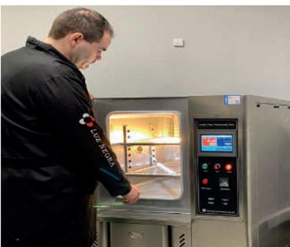
Cámara de temperatura y humedad que nos permite realizar test de shock termal para medir la resistencia de los productos usados en los rótulos desde -40° hasta +125° y desde un 0% a un 99% de humedad.
