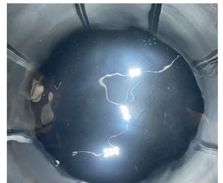
Tanque de estanqueidad que nos permite medir hasta IP68 nivel de estanqueidad.
