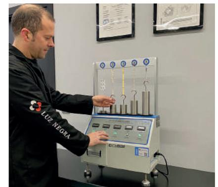
Máquina que nos permite medir la resistencia y fortaleza de soldaduras en tiras flexibles y la resistencia de adhesión de las cintas adhesivas de doble cara tanto en tiras flexibles como en módulos leds.
