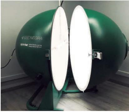
Espectroradiómetro con esfera de 150cm para verificar y asegurarnos que la luminosidad de los leds es la adecuada y la temperatura de color no sufre variaciones.
